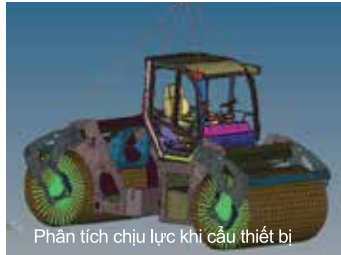
Phân tích chịu lực khi cấu thiết bị
